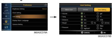
$\begin{array}{lll} \cdot & \text{Volume} & : \; \ell \leftrightarrow \text{gal} \\ \cdot & \text{Temperature} : \ ^\circ \text{C} \leftrightarrow ^\circ \text{F} \\ \cdot & \text{Distance} & : \text{km} \leftrightarrow \text{mile} \\ \cdot & \text{Weight} & : \text{ton} \leftrightarrow \text{lb} \end{array}$
